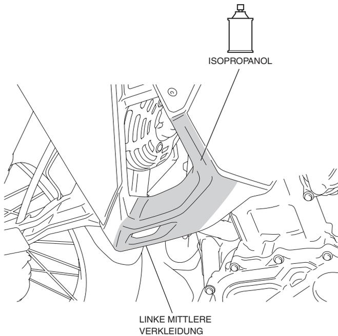
3. Ziehen Sie die Schutzfolie des Klebebands vom linken Deflektor ab, wie in der Abbildung dargestellt.
