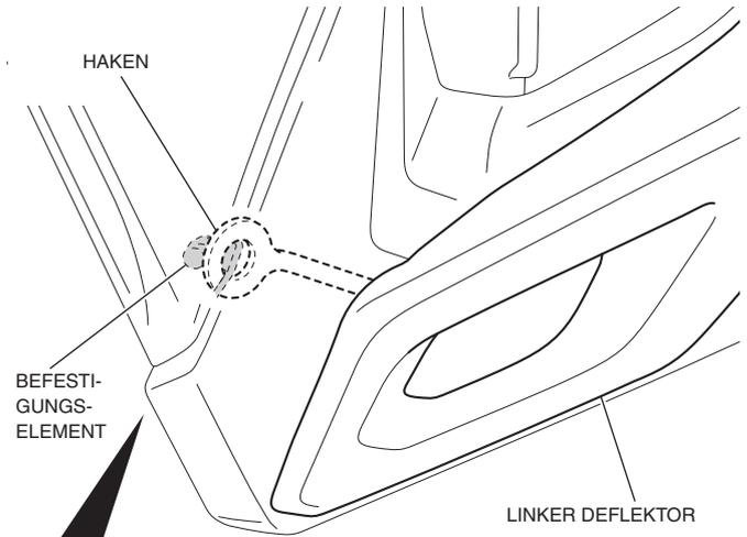
**Bringen Sie den Haken des linken Deflektors am Befestigungselement an und ziehen Sie dabei die linke mittlere Verkleidung nach außen.**
